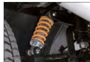
Sospensioni anteriori con schema automobilistico. Automotive design front suspension. Ammortizzatori a retro treno. Shock absorber at rear wheels.
